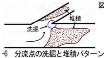
図-6 分流点の洗掘と堆積パターン
